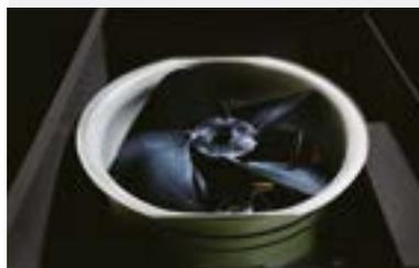
Boca de descarga curvada del ventilador, de nuevo diseño, para una mejor aerodinámica.
