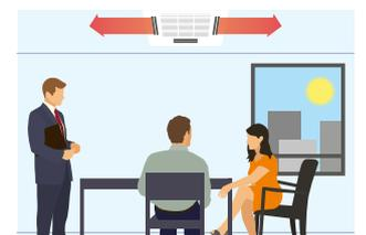
Flujo de aire indirecto mediante la detección de movimiento
